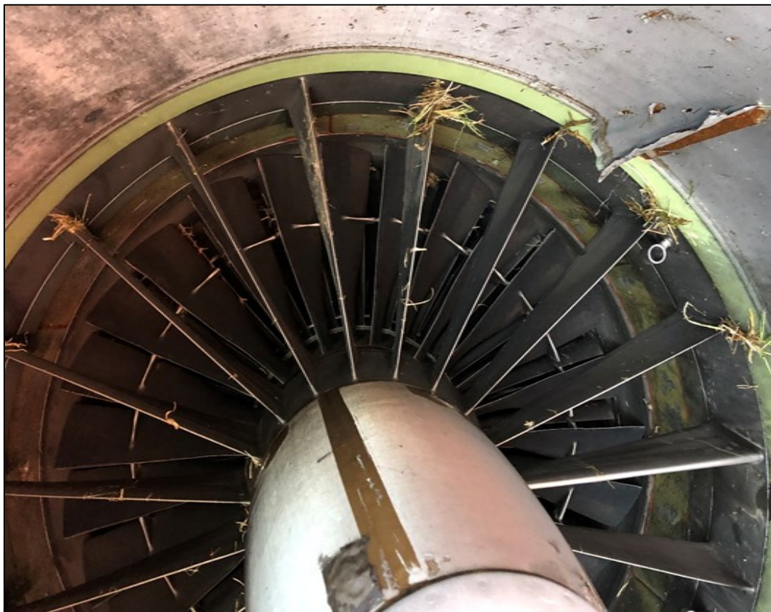
Fotografía No. 3: Daños causados al motor por la ingesta de pasto
