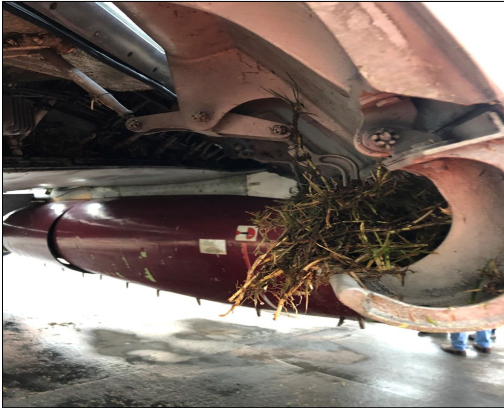
Fotografía No. 2: Daños causados a la aeronave por la ingesta de pasto
